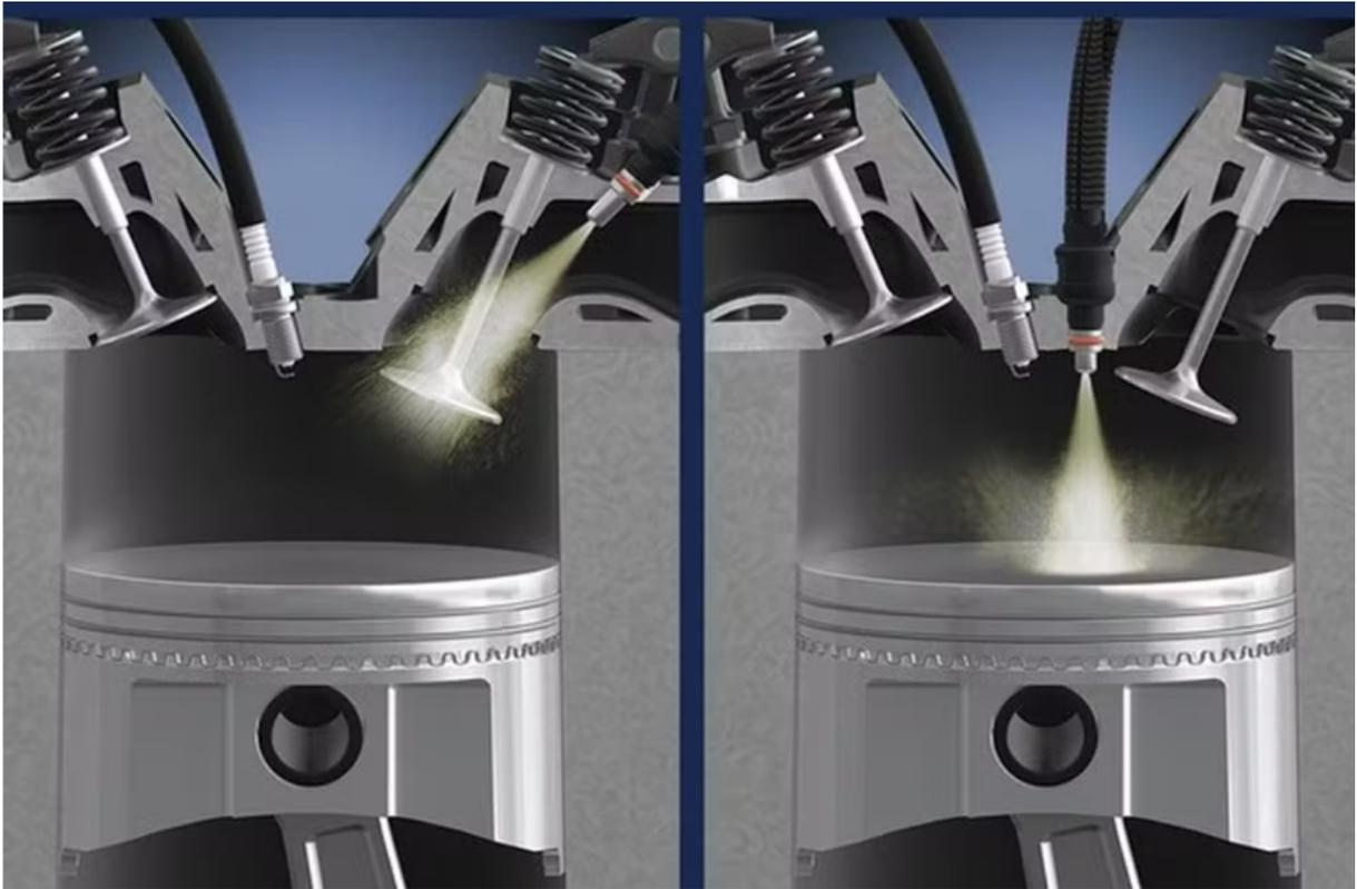
**Figura 4** – Injeção indireta (esquerda) e injeção direta (direita)
