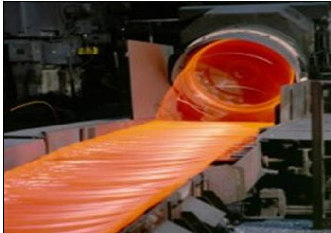
Figura 2 – Processo de transformar o fio-máquina em bobina
