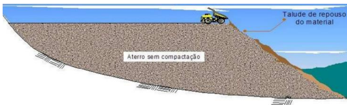
Figura 8 - Construção de pilha de estéril do modo descendente (Fonte: Freitas, 2004).
