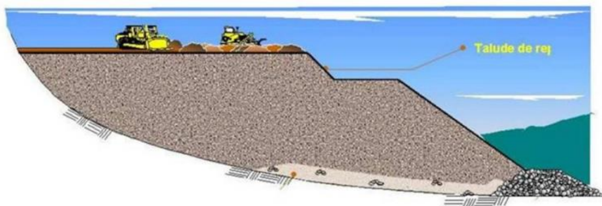
Figura 7 - Construção de pilha de estéril do modo ascendente por camadas (Fonte: Freitas, 2004).
