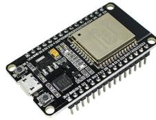
Figura 2.3 – Microcontrolador ESP32. Fonte: Savarati(2025)
