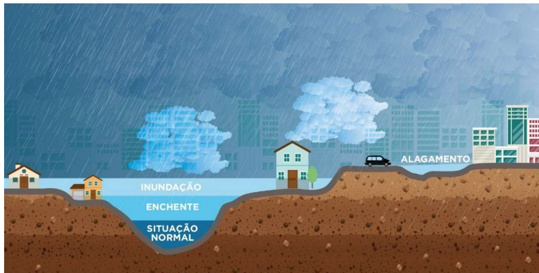
Figura 3 - Diferença entre enchentes, inundações e alagamentos.
