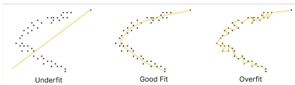
Figura 2.4 – Exemplo de como o modelo pode se adaptar aos dados de teste.
