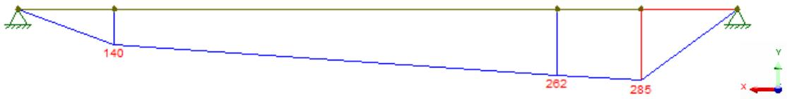
Figura 41: Diagrama momento fletor plano XY – Eixo 1
