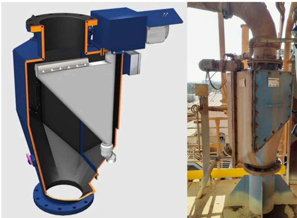
**Figura 10 : Amostrador Gravitacional Essa-FLSmith – Esquema e Equipamento no campo**
