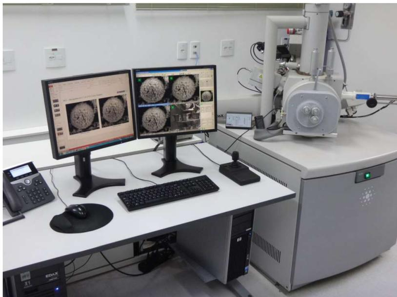
**Figura 13 : Microscópio Eletrônico de Varredura (MEV), equipamento Quanta-450 da marca FEI**
