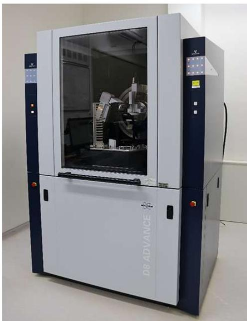
**Figura 12 : Difratômetro D8 Advance da marca Bruker**
