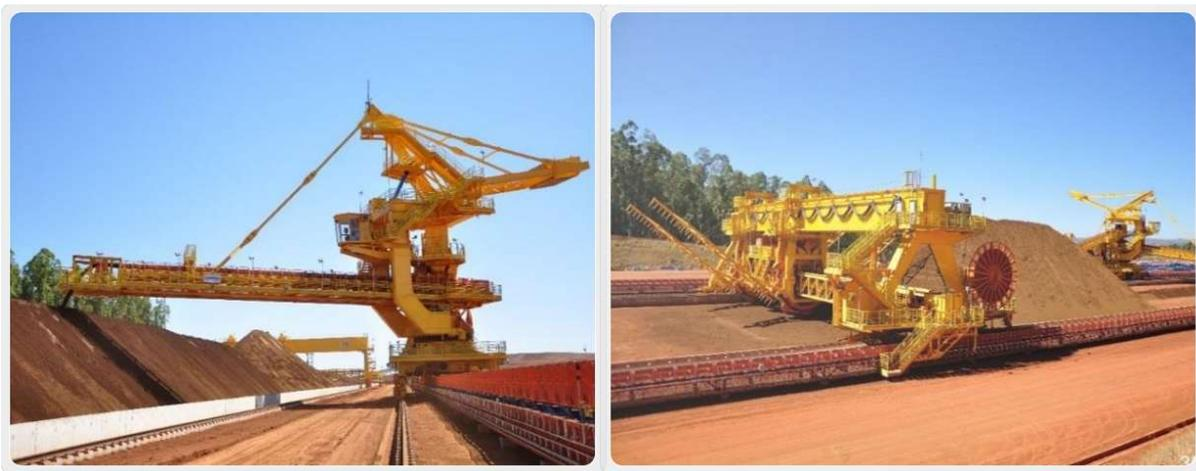
**Figura 4 : Empilhamento e Retomada – Processo Chevron - CBMM**
