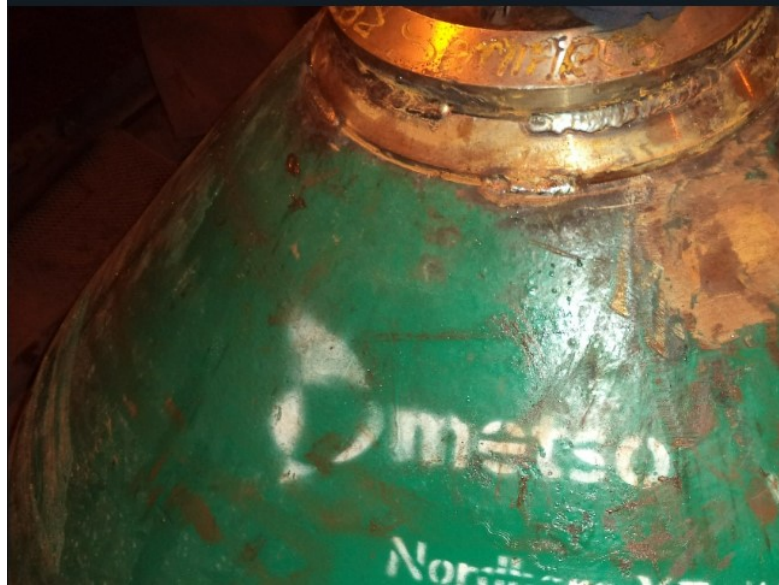
Figura 12: Desgaste por impacto em carcaça Fonte: Pesquisa direta (2024)
