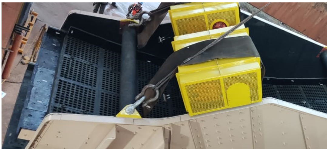
Figura 4: Peneira vibratória horizontal Fonte: Adaptado Chaves e Peres (2003)
