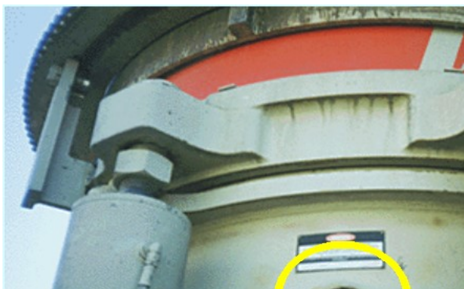
Figura 11: Desgaste por abrasão na carcaça principal Fonte: Pesquisa direta (2024)
