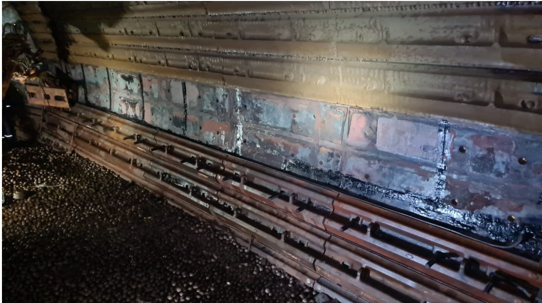
Figura 17: Troca das placas de revestimento do moinho Fonte: Pesquisa direta (2024)
