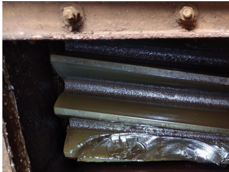
Figura 16: Dentes da engrenagem do moinho quebrada Fonte: Pesquisa direta (2024)
