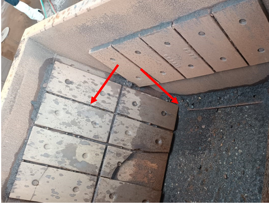
Figura 24: Desgaste na chapa de desgaste do chute Fonte: Pesquisa direta (2024)
