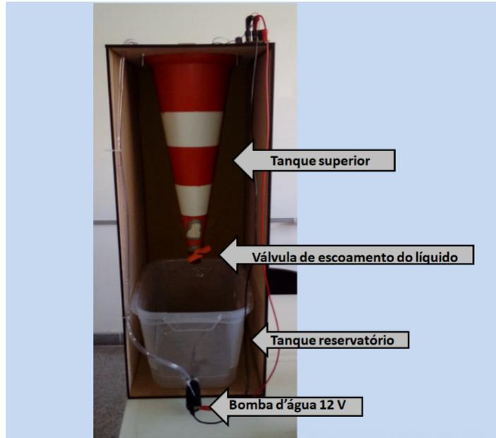
Figura 49 – Instrumentação da planta.
