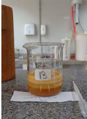
Figura 54 – Transferindo material para o picnômetro
