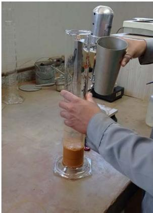
Figura 44 – Ensaio de sedimentação
