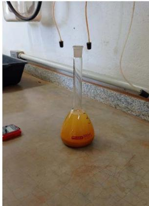
Figura 58 – Pesagem conjunto picnômetro + água + solo
