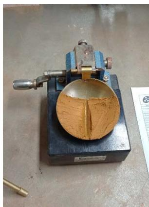
Figura 50 – Ranhura com as bordas inferiores encontradas cerca de 1,3 cm após os golpes
