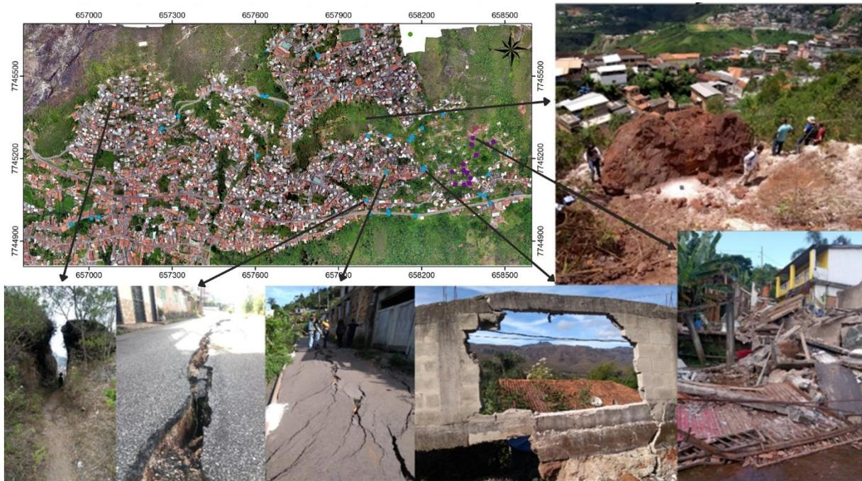
**Figura 8.2** - Mapa de pontos visitados em campo, com exemplos de acidentes geotécnicos.
