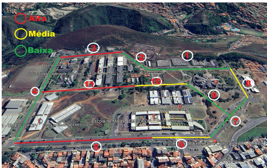
Figura 32: Trechos de declividade do traçado ciclovitário.
