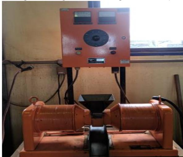
Inicialmente, preparou-se uma polpa com a amostra e foram selecionadas pequenas esferas de aço de tamanho variado e colocadas dentro da caixa por onde passava a amostra e que possuía contato direto com as bobinas do separador magnético. Com isso, o campo magnético era ligado e ajustado de acordo com as correntes previamente fixadas (1A e 2A). Para todos os ensaios foram utilizados aproximadamente 500 gramas de amostra e a polpa preparada possuía 25% de sólidos.
