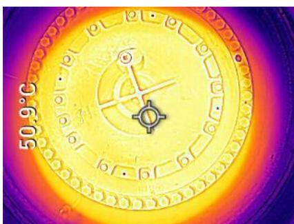
Figura 26 – Imagem termográfica, temperatura do comando final dianteiro direito. Fonte: Autor
