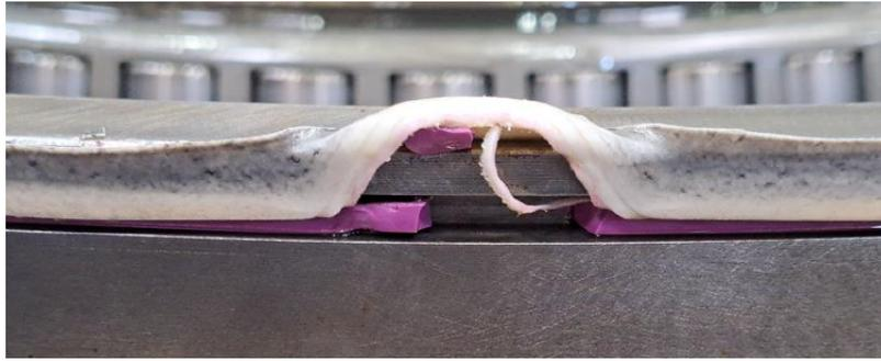
Figura 4 – Anel do pistão deformado. Fonte: Autor
