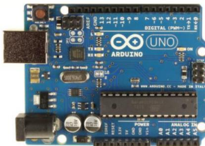
Figura 5 – Placa Arduino modelo UNO. Fonte: (ARDUINO, 2023)
