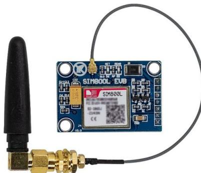
Figura 12 – Modulo GSM 8001 com antena.Fonte: (CATALEX, 2023)
