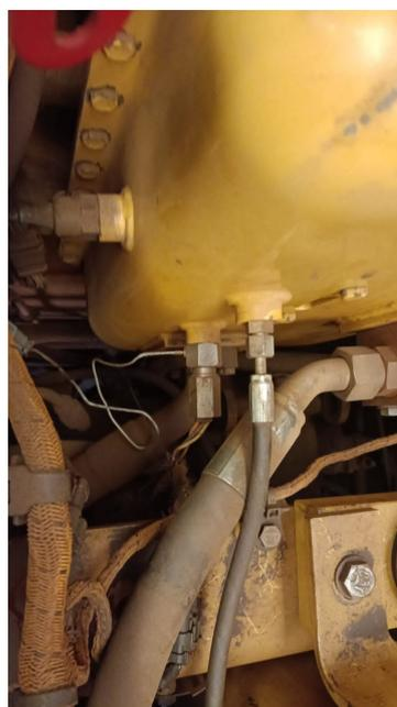
Figura 23 – Sensor de temperatura instalado no tanque de arrefecimento. Fonte: Autor
