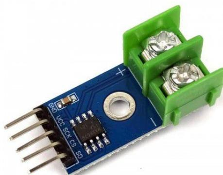
Figura 7 – Conversor termopar.Fonte: ([TECHNOLOGIES, 2023](#))
