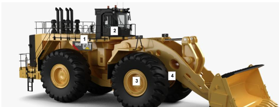
Figura 22 – Local de instalação do sensor de medição de temperatura. Fonte: Autor
