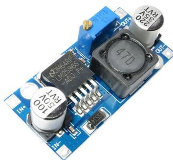
Figura 10 – Regulador de tensão LM2576.Fonte: ([ELETRÔNICOS, 2023](#))
