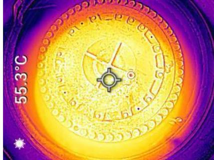
Figura 27 – Imagem termográfica, temperatura do comando final dianteiro esquerdo. Fonte: Autor
