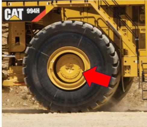
Figura 2 – Comando final Caterpillar 994H. Fonte: (CATERPILLAR, 2013)
