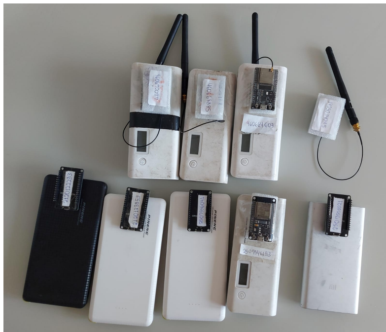
Figura 28 – Estrutura das placas com identificação e alimentação energética.
