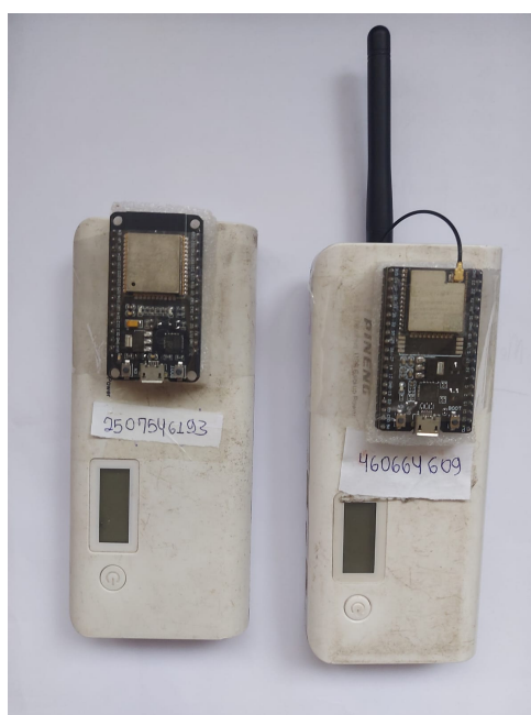
Figura 22 – Montagem das placas ao carregador portátil.
