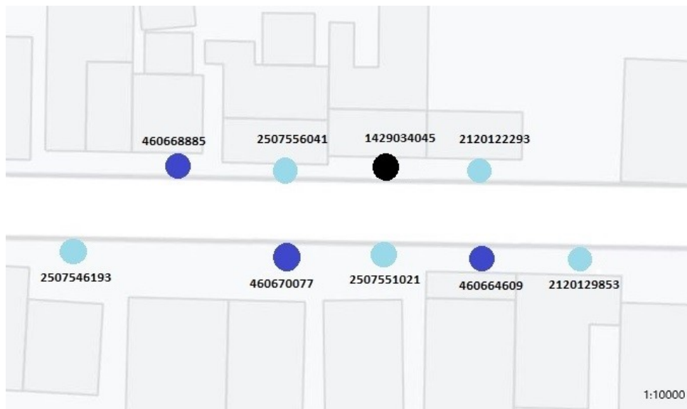
Figura 29 – Disposição geográfica dos elementos da malha em meio urbano, sendo o ponto preto o nó base, os pontos em azul-escuro as placas de antena externa e os pontos em azul-claro as placas de antena embutida.
