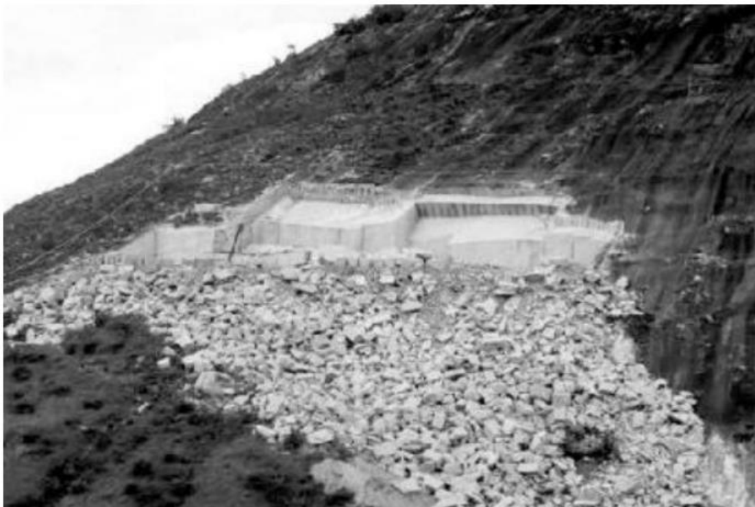
Figura 8: Lavra por desabamento.
