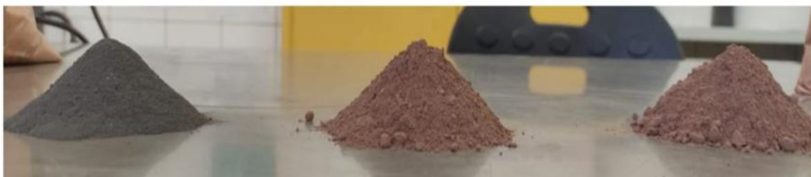
Figura 20 - *Dump* - produtos separação magnética de alto gradiente
