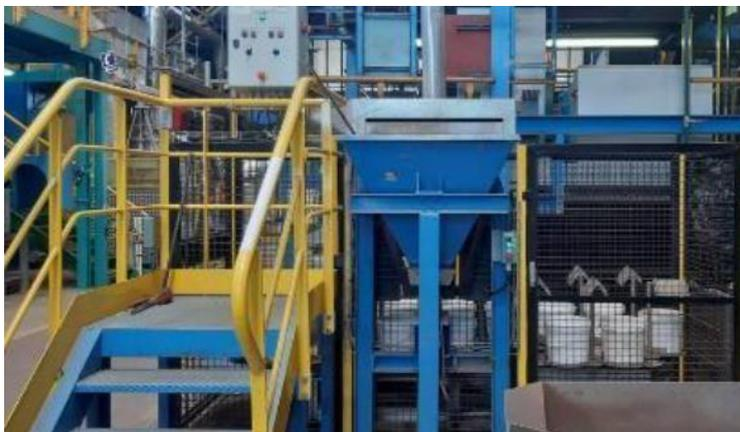
Figura 7 - Amostrador carrossel de baldes
