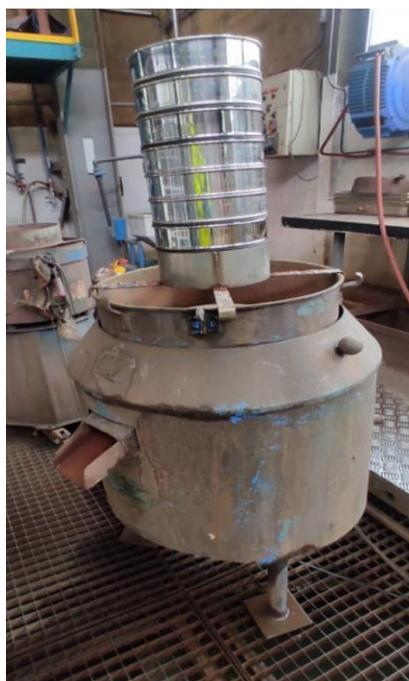
Figura 10 - Peneiramento a úmido – SINEX
