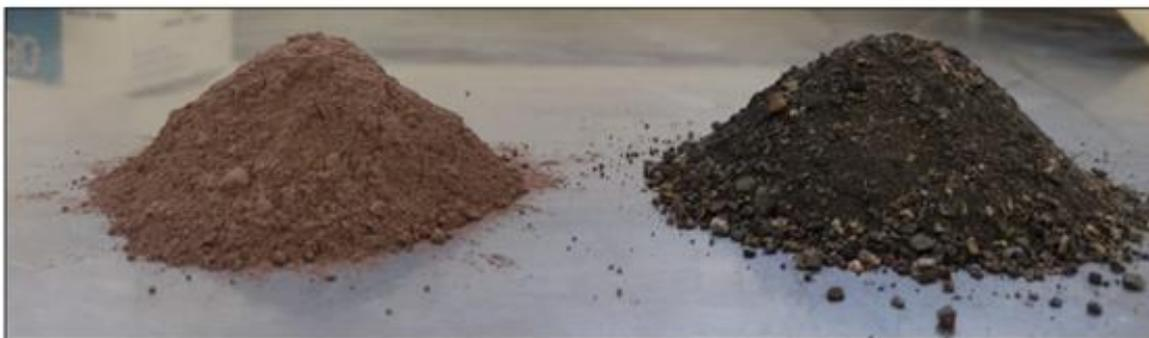
Figura 19 - *Dump* - produtos separação magnética de baixo gradiente
