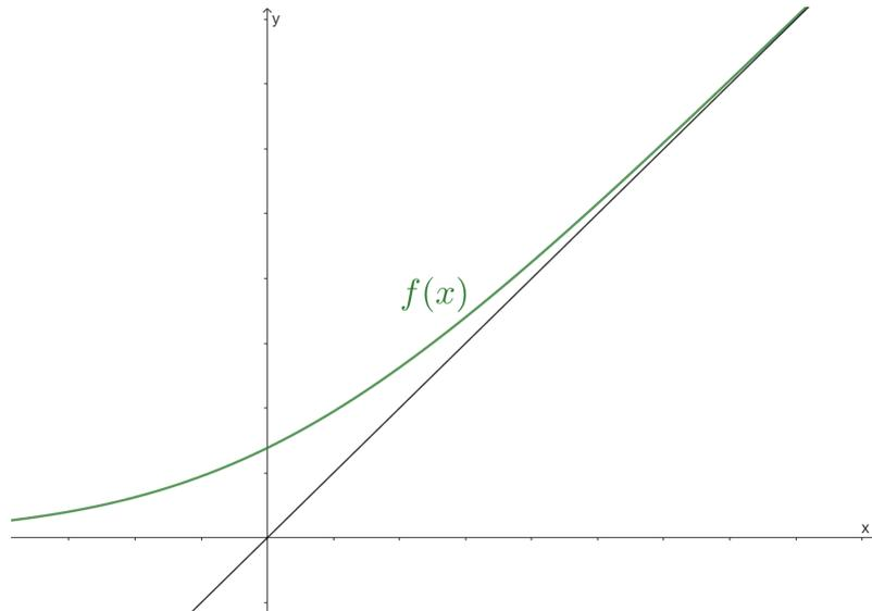
Figura 3.2: Na figura, é possível observar como o gráfico da função  $f$  se aproxima arbitrariamente do gráfico da função identidade para  $x$  suficientemente grande.
