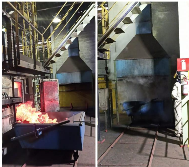
Figura 5.5. Desenformamento e extinção do coque produzido.
