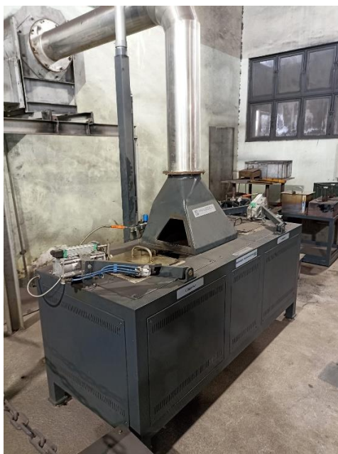
Figura 4.3. Forno de soleira aquecida do laboratório da Gerdau.
