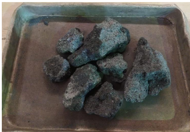
Figura 5.6. Coque produzido na unidade piloto com adição de bagaço de cana pirolisado.
