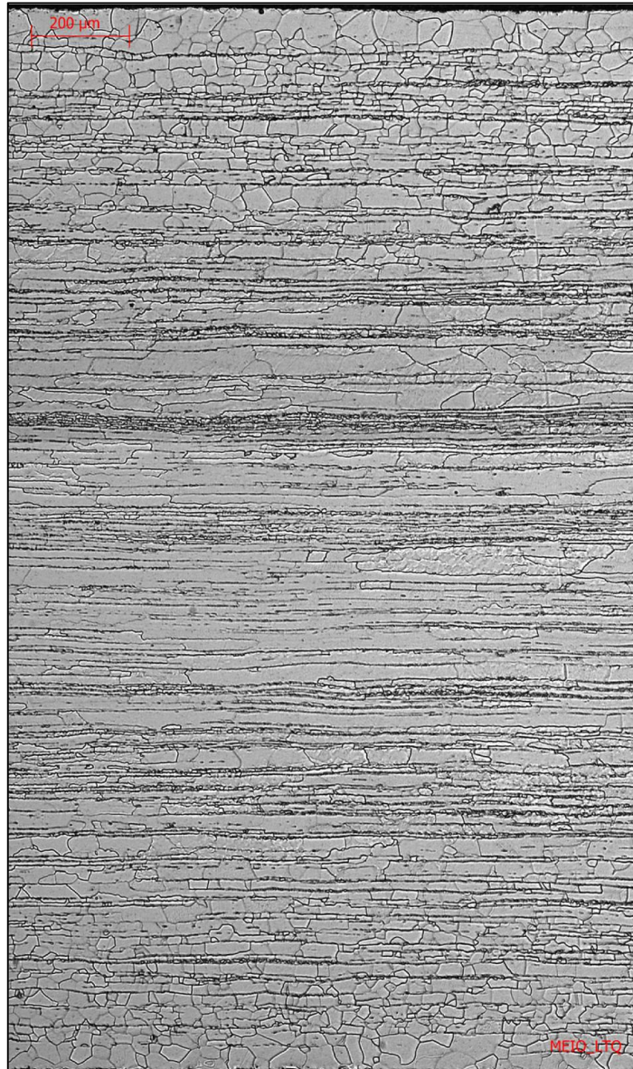
Figura 5.2. Microestrutura do aço estudado após LTQ. Seção longitudinal em relação à direção de laminação, mostrando toda a espessura – MO. Ataque: nital 5% - 50x.
