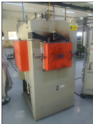
Figura 4.3. Forno estacionário para a etapa de aquecimento do tratamento térmico.
