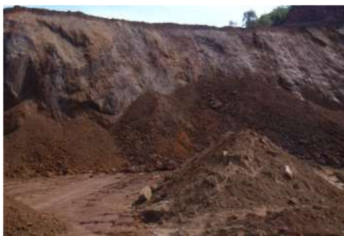
Figura 36 - Itabirito hidratado (Sousa, 2011)
