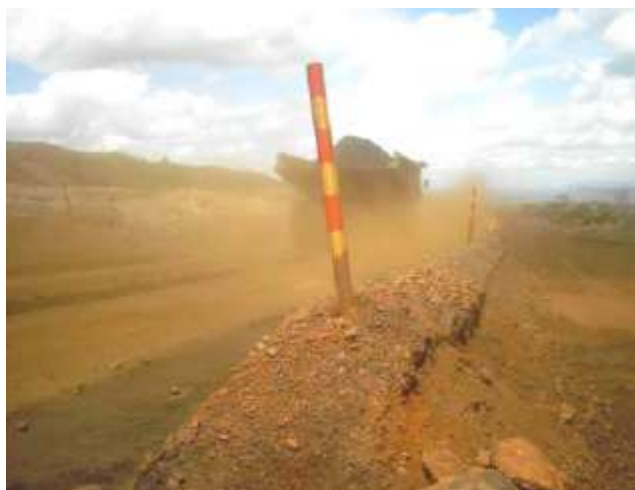
Figura 11 - Condições precárias de visibilidade devido à excessiva formação de poeira
