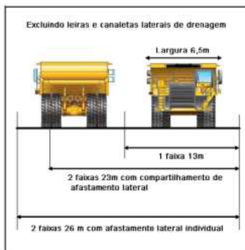
Figura 2 - Exemplo de perfil esquemático de largura de estrada para caminhão fora de estrada Caterpillar (Mod. Visser, 2008)
