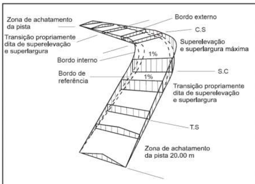
Figura 4 - Representação esquemática da superelevação (Oliveira Filho et al. , 2010b)
