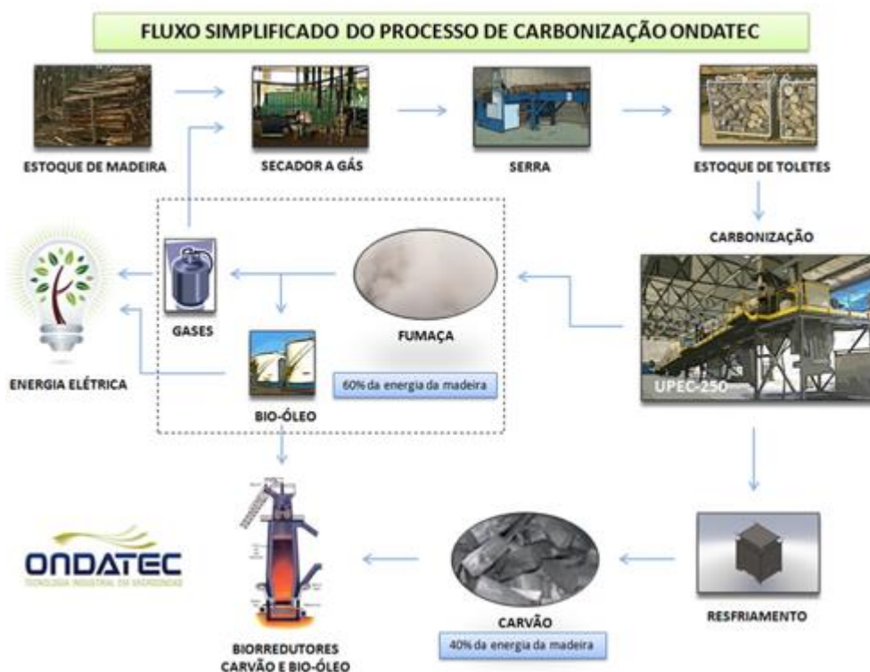
Figura 14 - Fluxo simplificado do processo de carbonização Ondatec. (ONDATEC, 2013)
