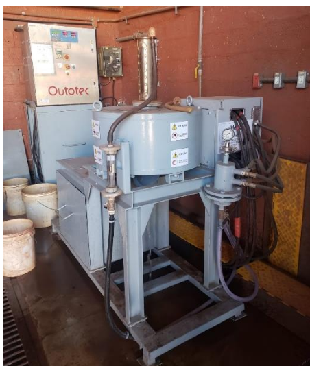
Figura 19 - Separador magnético vertical pulsante de alto gradiente – Escala de bancada
