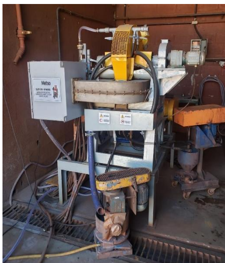
Figura 21 - Separador magnético vertical pulsante de alto gradiente – Escala piloto
