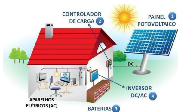
Figura 2 – Sistema isolado de geração fotovoltaica.
