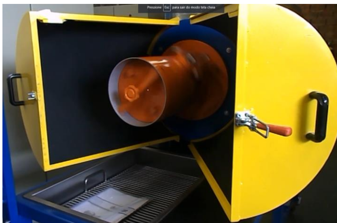
Figura 10 – Moinho de bolas (escala de bancada)
