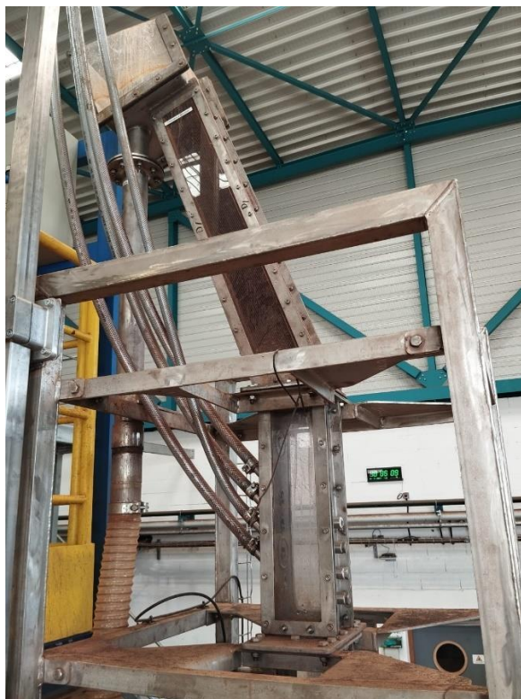
Figura 12 - Reflux Classifier modelo RC 100
