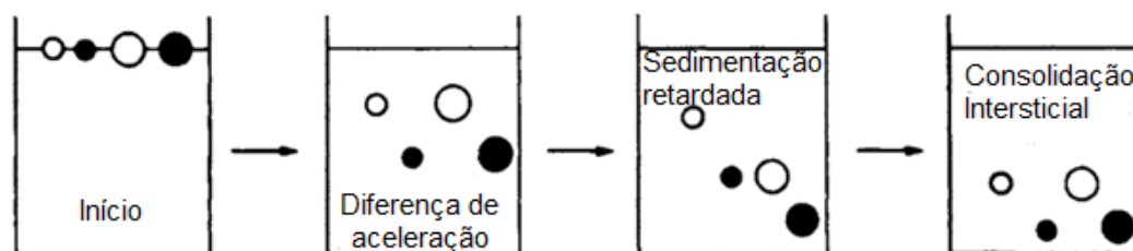
Figura 4 – Esquema simplificado dos processos chave da separação gravítica
