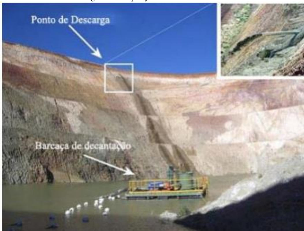
Figura 19 - Disposição em cava a céu aberto
