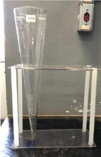
Figura 7: Cone de Imhoff utilizado para aferir o volume dos flocos sedimentados
