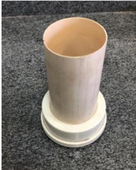
Figura 6: Reator utilizado nos testes de floculação
