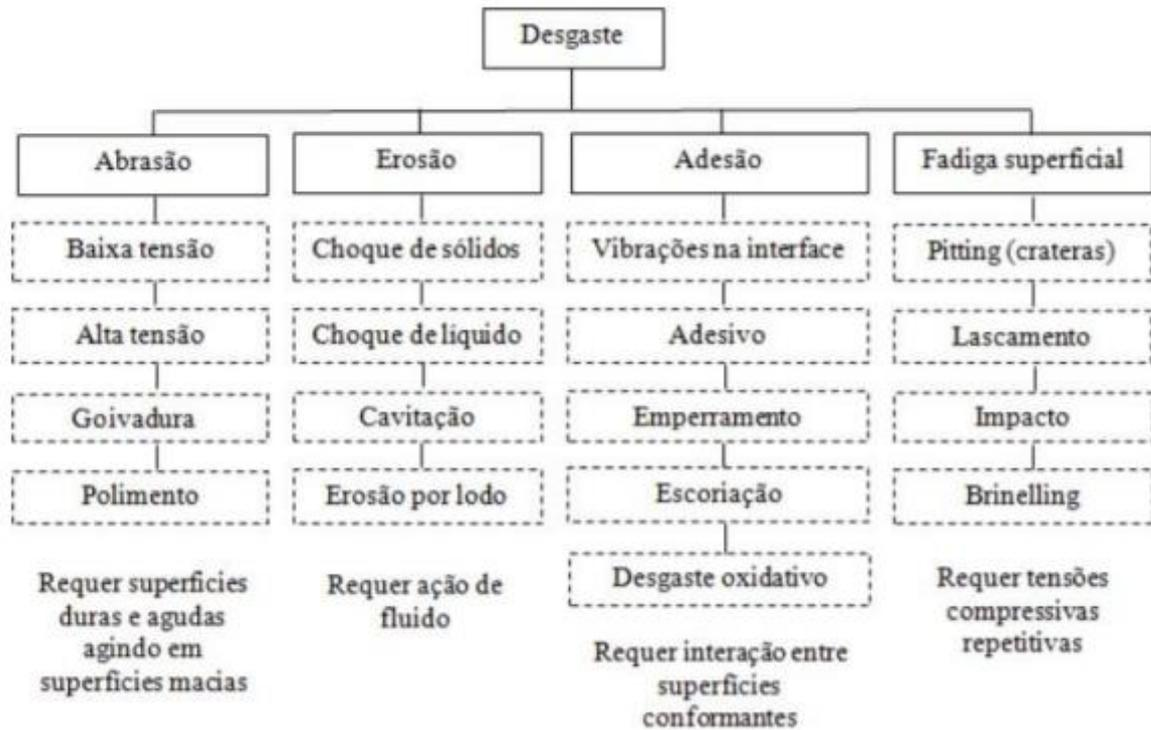
Figura 5 - Classificação dos tipos de desgaste e suas subdivisões.
