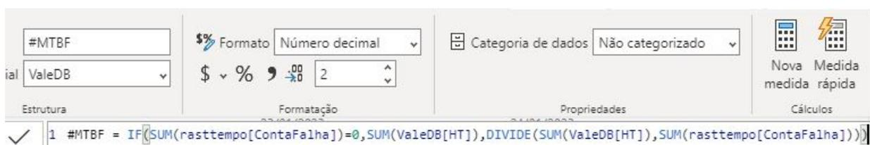
Figura 21 – Equação utilizada para construir o indicador de Tempo Médio Entre Falhas (MTBF) no Power BI. Fonte: Adaptada pelo autor, Microsoft Power BI (2023)
