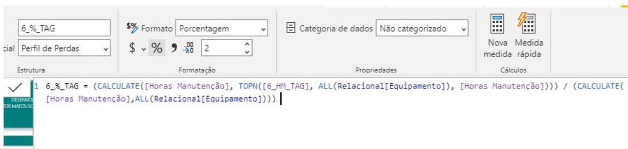
Figura 26 – Cálculo utilizado para determinar a porcentagem acumulada no Power BI. Fonte: Adaptada pelo autor, Microsoft Power BI (2023)
