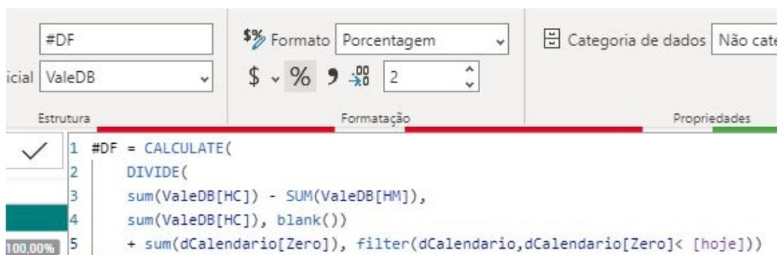
Figura 20 – Equação utilizada para construir o indicador de Disponibilidade Física (DF) no Power BI. Fonte: Adaptada pelo autor, Microsoft Power BI (2023)
