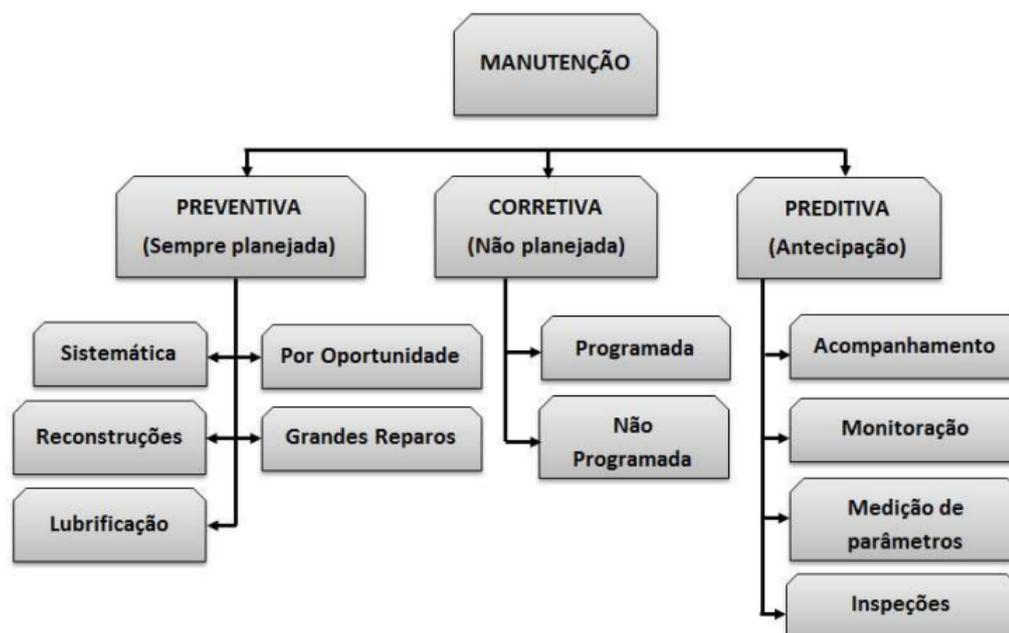
Figura 2 – Classificação dos tipos de manutenção. Fonte: (ABRAMAN, 2005)
