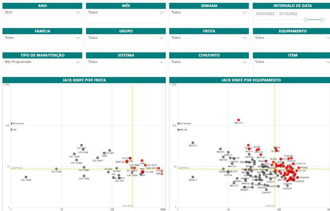
Figura 42 – Painel do Perfil do Diagrama Jack-knife de Equipamentos Móveis no Power BI (Parte 1/2). Fonte: Adaptada pelo autor, Microsoft Power BI (2023)
