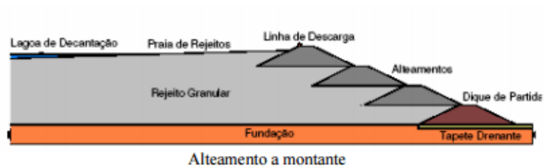
Figura 7. Barragem do tipo alteamento a montante
