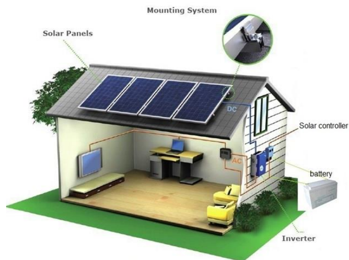
Figura 2.5 – Sistema Fotovoltaico Autônomo ou Isolado
