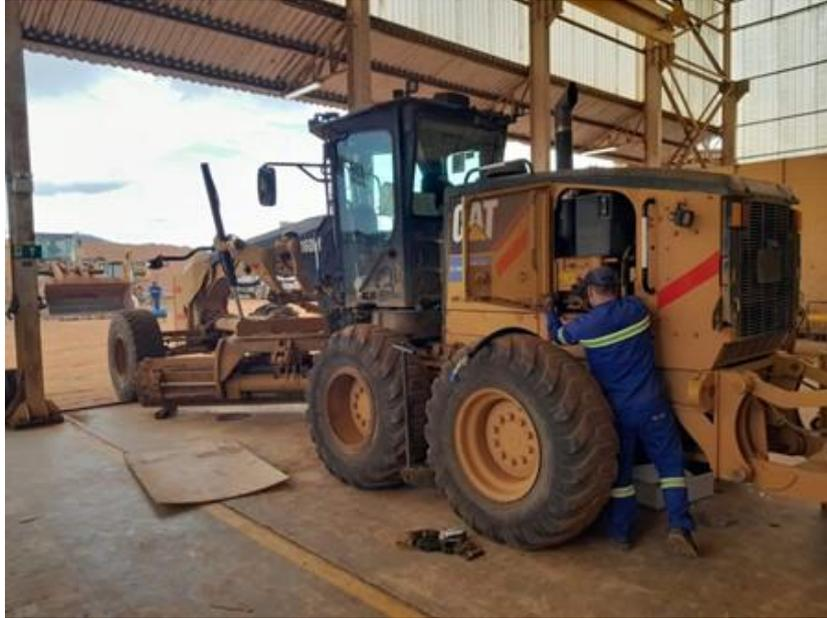
Figura 9: Manutenção em Motoniveladora.
