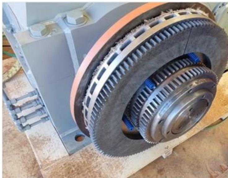
Figura 12: Manutenção em Embreagem do desagregador.
