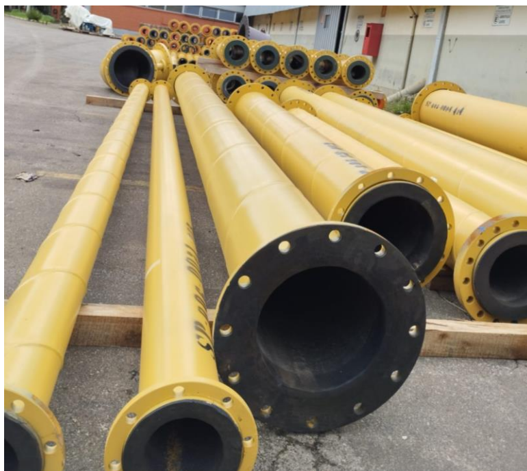
Figura 25 - Tubulação de aço revestida de borracha Fonte: Pesquisa direta (2023)
