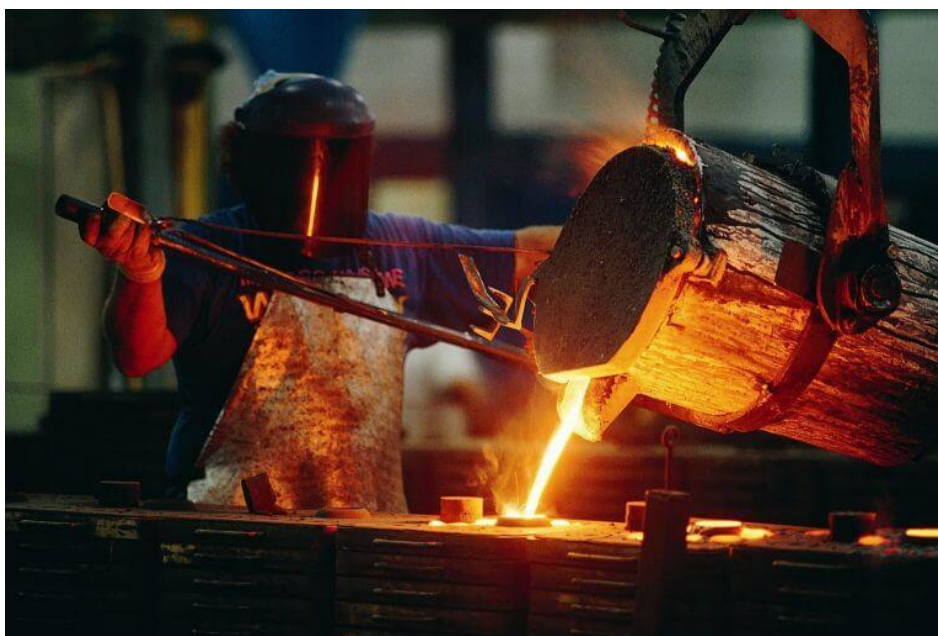
Figura 9 - Processo de fundição de tubos Fonte: Tubos oliveira (2019)
