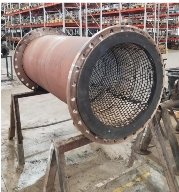
Figura 23 - Tubulação de aço revestida de borracha e cerâmica Fonte: Pesquisa direta (2023)
