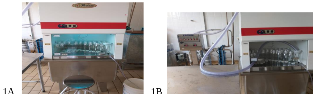
Figura 1A e 1B – Bancada de Fluxo Laminar, Linha PCR T2 Eco da Pachane utilizada no envase.
