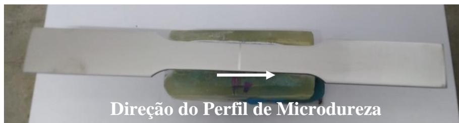
Figura 4.5: Corpo de prova lixado, polido, embutido e atacado quimicamente com reagente Kroll, detalhando a direção do sentido do perfil de microdureza.
