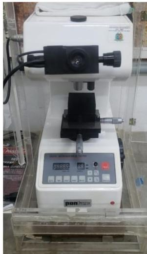
Figura 4.4: Microdurômetro do Laboratório LTM/DEMET/EM/UFOP utilizado para realização dos ensaios de microdureza Vickers.
