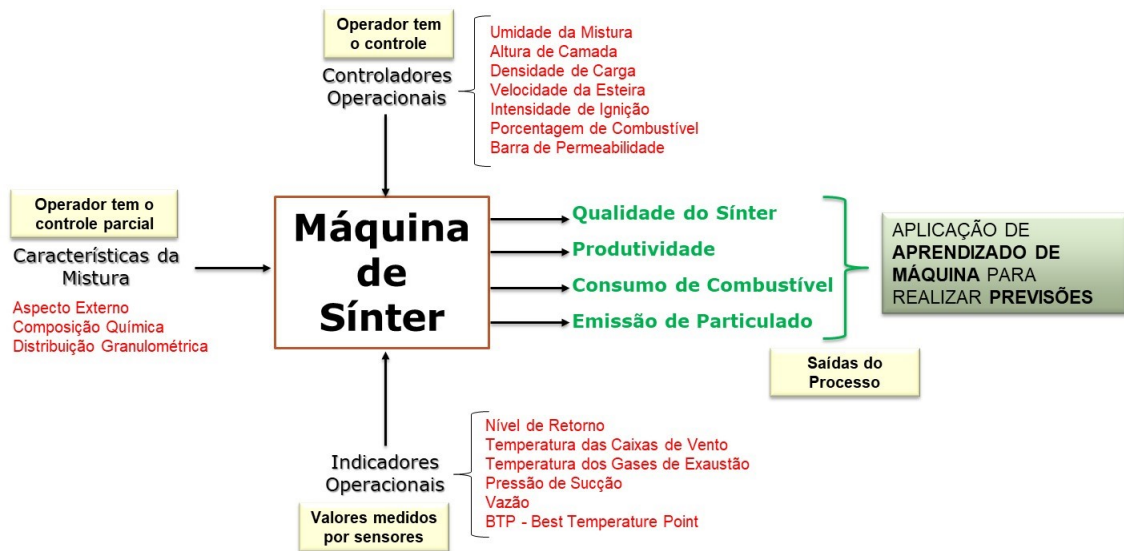
Figura 5 – Estrutura de variáveis da sinterização e proposta de aplicação de aprendizado de máquina para realizar previsões.
