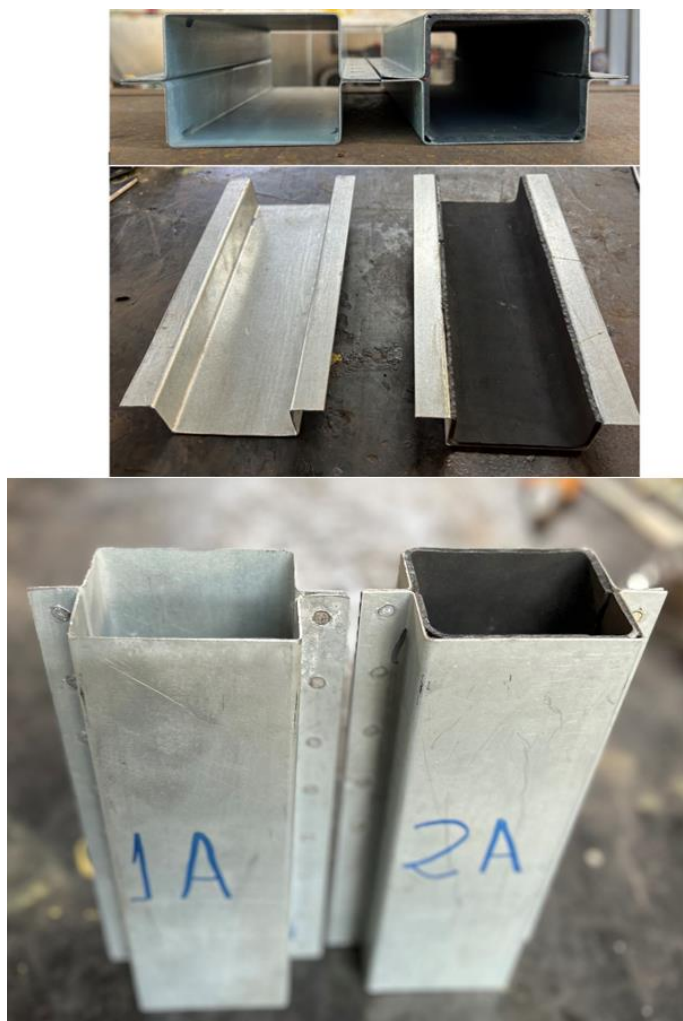
Figura 16: Comparativo entre os corpos de prova: amostra 1A (sem revestimento) e amostra 2A (com revestimento). Fonte: Pesquisa direta, 2023.
