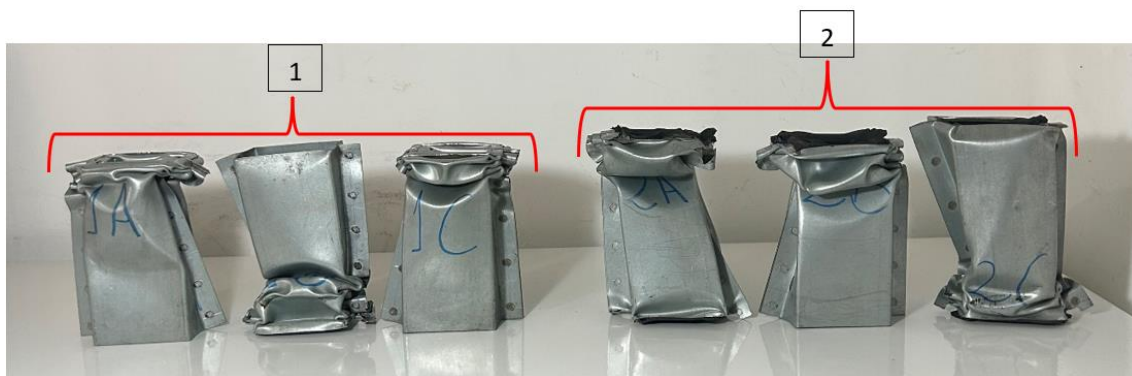
Figura 22: Deformação final das longarinas: grupo 1 (sem revestimento) e grupo 2 (com revestimento). Fonte: Pesquisa direta, 2023.
