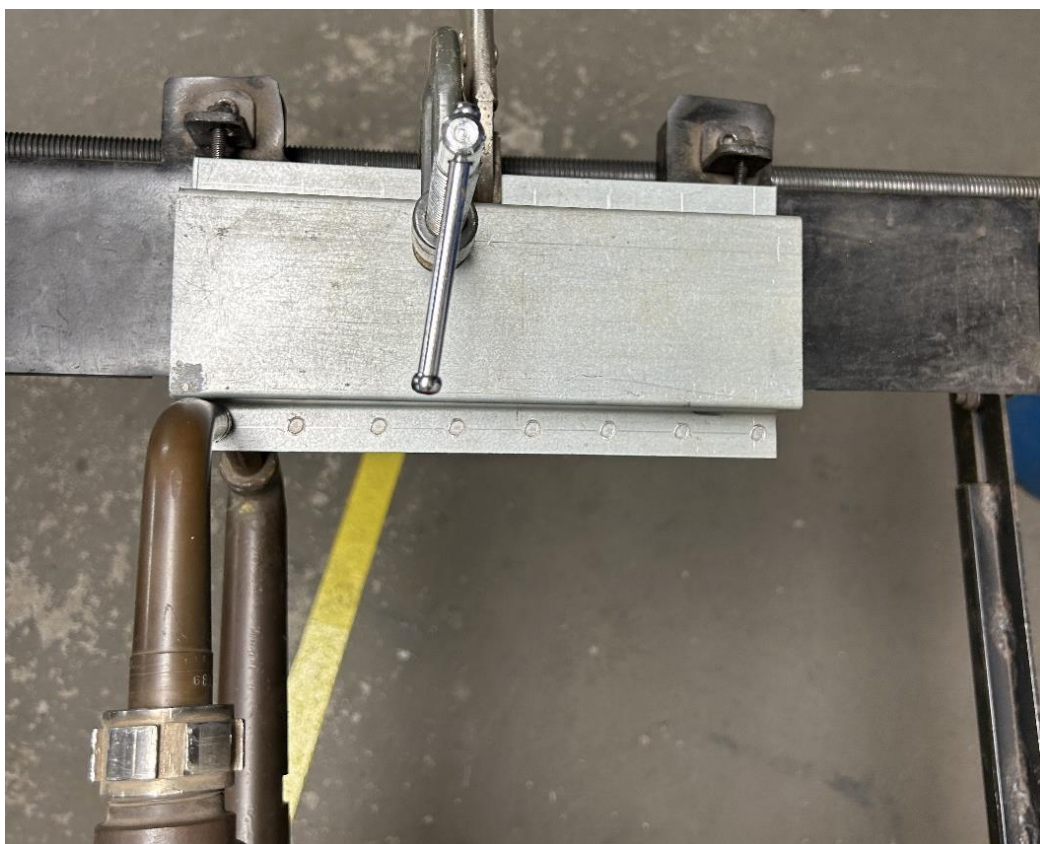
Figura 13: Chapas soldadas por soldagem a ponto.
