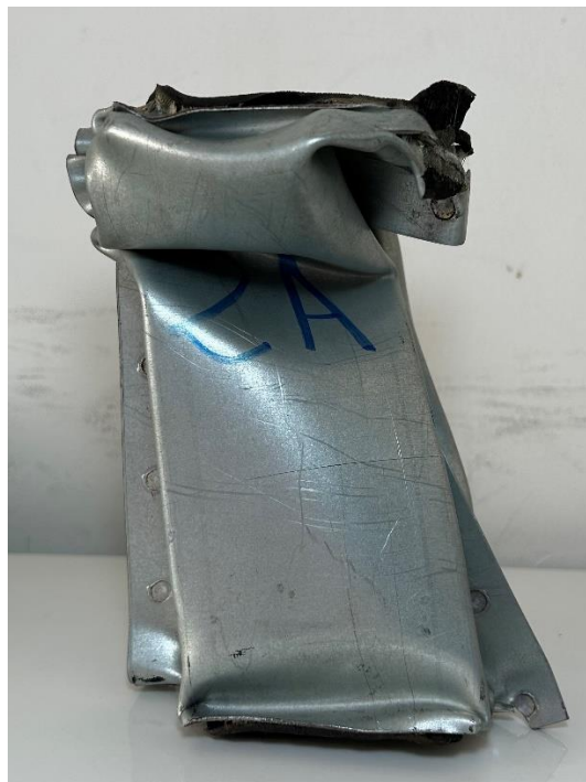
Figura 29: Longarina 2A após ensaio. Fonte: Pesquisa direta, 2023.
