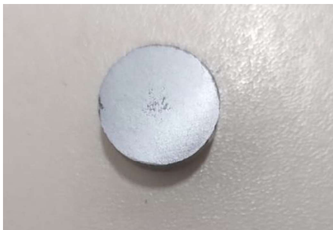
Figura 11 - Amostra de compósito de alumínio reforçada com rejeito de manganês. Fonte: Pesquisa direta (2023).
