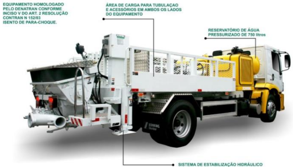
Figura 17 - Chassi caminhão bomba lança de concreto. Fonte: Revista Almeida (2016).
