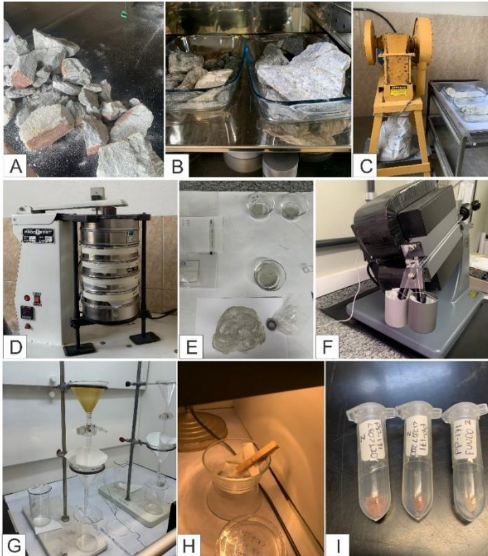
Figura 1.5 - Preparação de amostras para análise geocronológica
