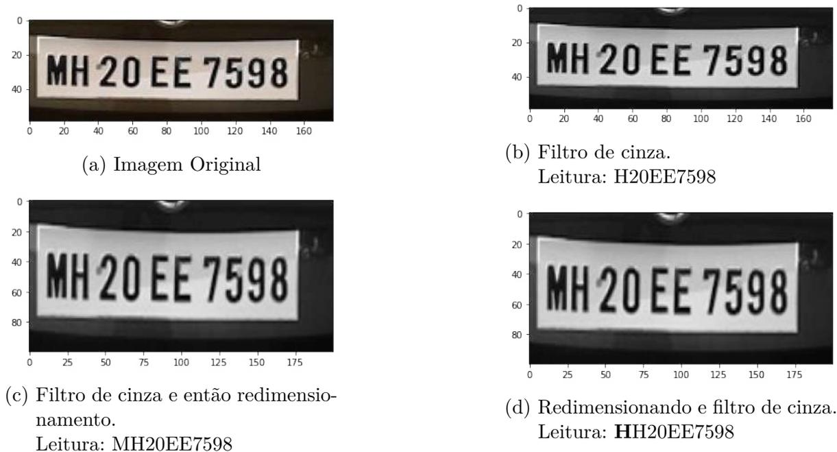
Figura 3.9 – Teste 3 de leitura com três diferentes metodologias.
