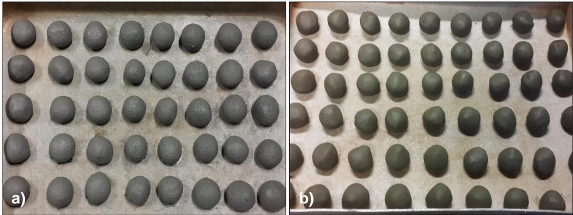
Figura 7 – *Pellets* produzidos manualmente para confecção dos clínqueres: a) *pellets* de clínquer belítico de resíduos; b) *pellets* de clínquer belítico de referência.
