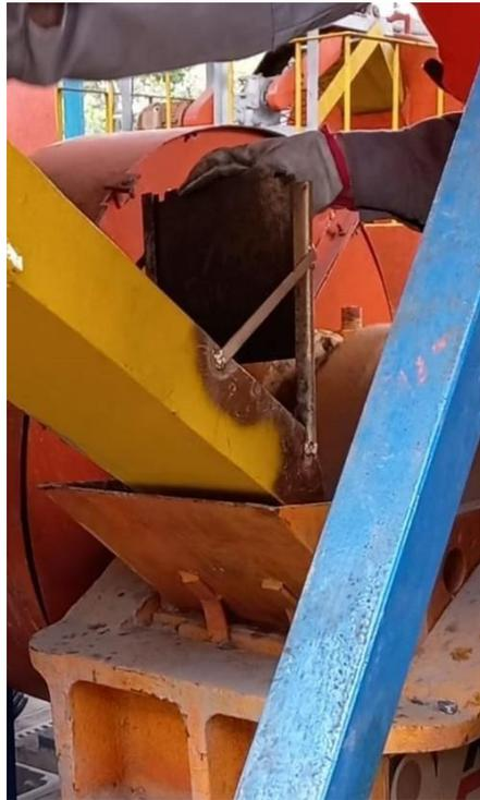
Como mencionado, na segunda hora do teste foi realizada a amostragem. As amostras coletadas foram retiradas do *trommel* (retido e passante) e o produto do britador, totalizando em quatro bateladas com intervalo de 10 minutos entre cada uma.
