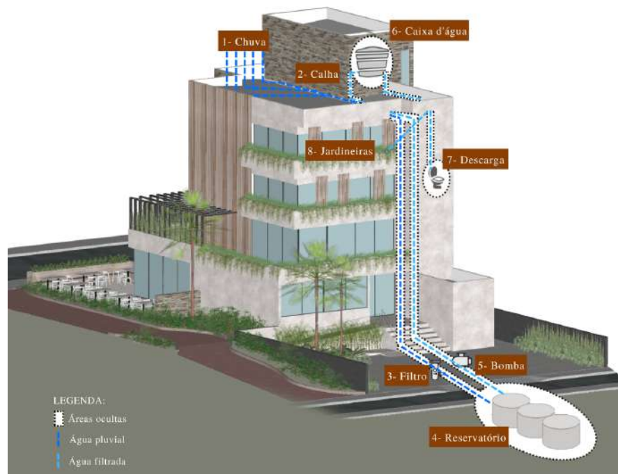
Figura 70 - Esquema da reutilização das águas pluviais.
