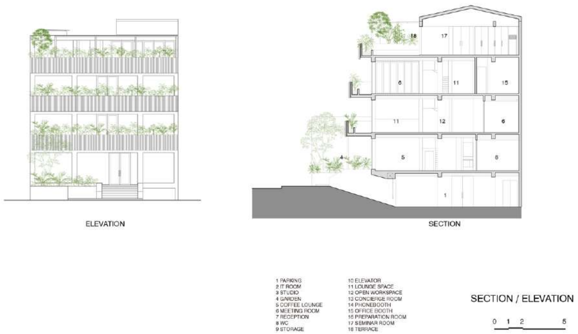
Figura 23 e 24- Elevação e corte do edifício.
