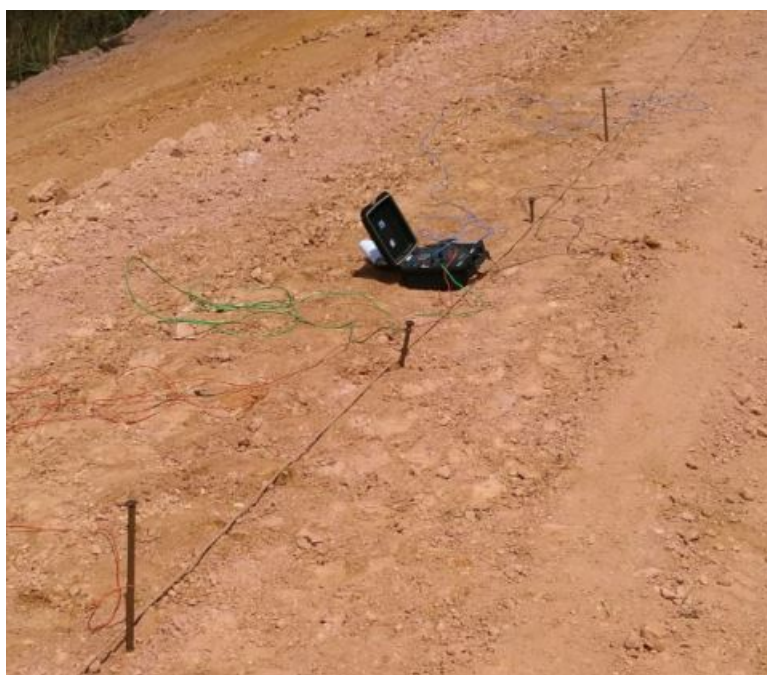
Figura 30 – Medida de resistividade do solo.
