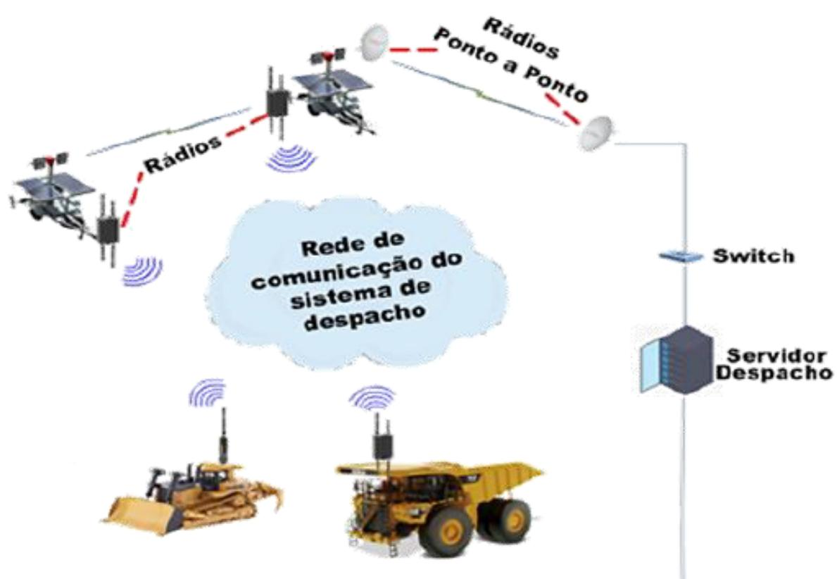
Figura 11 – Rede de comunicação do sistema de despacho. Fonte: Autor
