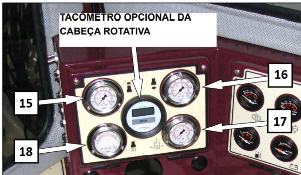
Figura 5 – Painel do manômetro do sistema. Fonte: Manual <sup>4</sup>
