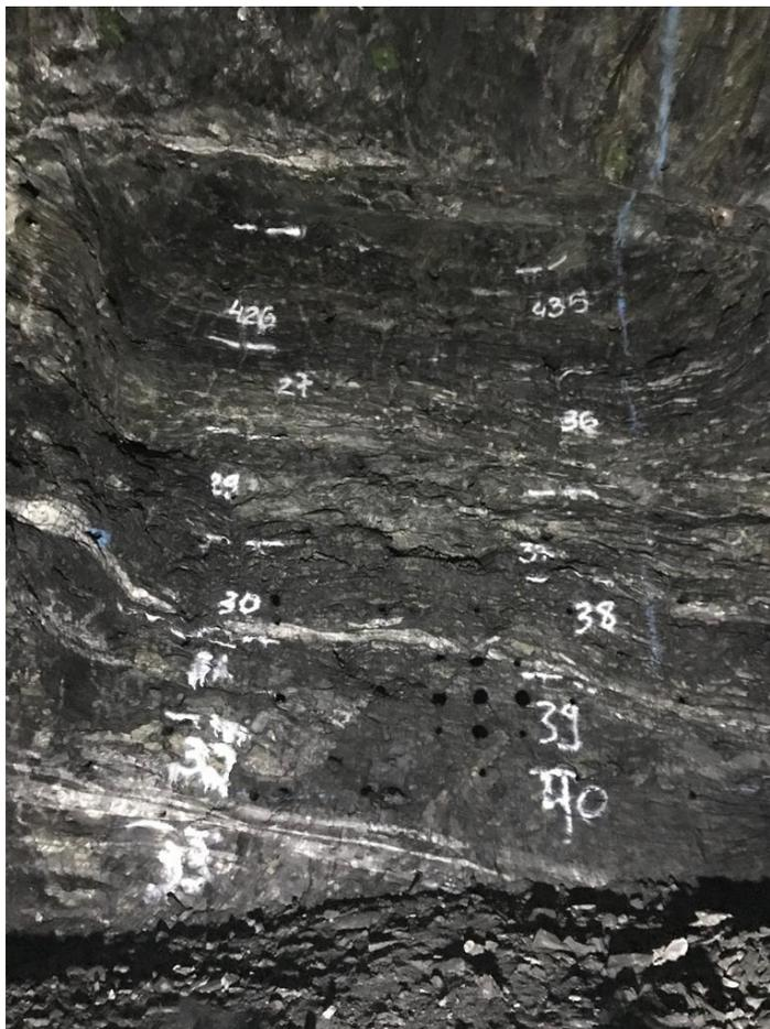
**Figura 5.3:** Foto de um internível em desenvolvimento onde pode-se observar as marcações feitas pelos amostradores, os números representam o local de coleta de cada amostra.
