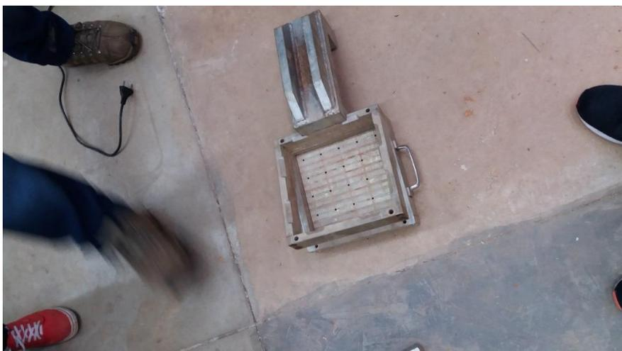
Após a montagem, a areia é transferida para a caixa de forma cuidadosa para que não haja perda de material. Com a areia dentro da caixa bipartida, mede-se a altura do corpo de prova que será ajustada de acordo com a necessidade, com ajuda de um soquete conforme figura 3.2.3. No caso específico do equipamento utilizado, a caixa possuía 7,2 centímetros de altura e o corpo de provas necessariamente tinha que ter 5 centímetros, então compactava-se até que sobrasse 2,2 centímetros.
