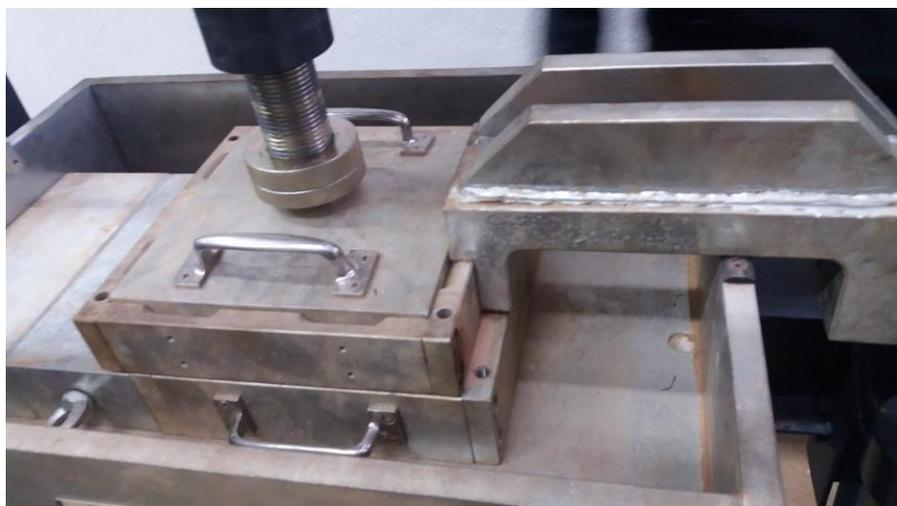
Após 8% de deformação na caixa bipartida, fora considerado que o ensaio estava terminado, pois após esse valor existe perda de material que vaza pelos cantos da caixa e aparece também uma leve inclinação da tampa e na parte superior da caixa, o que compromete os resultados a partir daí.
