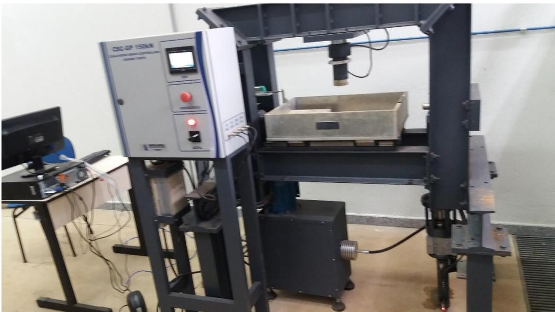
Com a caixa devidamente posicionada, figura 3.3.2, o equipamento é ligado e após todos os ajustes serem feitos, começa-se os ensaios que consistem da mesma forma do que fora explicado no item 2.5 deste trabalho, quando abordou-se os ensaios de cisalhamento, basicamente após ligado, é exercida a etapa de adensamento que se tratando de uma areia, acontece quase que de forma instantânea. Após essa etapa, tem-se início a etapa de cisalhamento propriamente dita.
