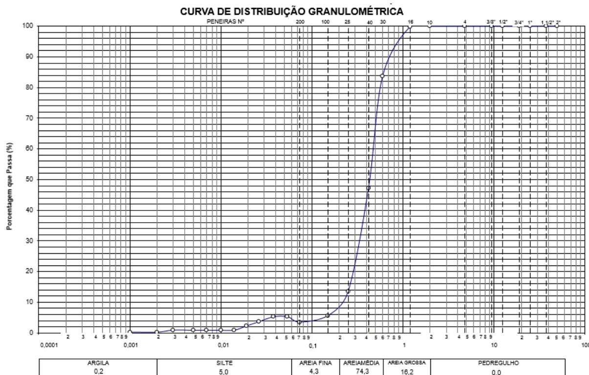
A partir da curva granulométrica apresentada, foi analisado o coeficiente de não uniformidade CNU e o coeficiente de curvatura CC.
